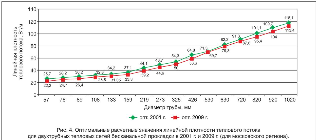
Рис. 4. Оптимальные расчетные значения линейной плотности теплового потока для двухтрубных тепловых сетей бесканальной прокладки в 2001 г. и 2009 г. (для московского региона).
