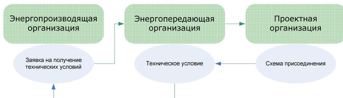
Технические условия на подключение объекта ВИЭ к электрическим сетям выдаются энергопередающей организацией на основании схемы присоединения (выдачи мощности) электростанции, разработанной специализированной проектной организацией, и содержащее схему подключения объекта ВИЭ к электрическим сетям.
